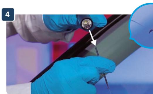
Usa un PUNZONE CON PUNTA IN TUNGSTENO nel foro e picchiettare delicatamente in alto fino a quando apparirà un mini occhio di bue (Se non si forma perforare leggermente più in profondità)
