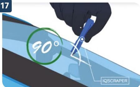
**ATTENZIONE:** tenere la lama con un angolo di 90° durante la raschiatura.
